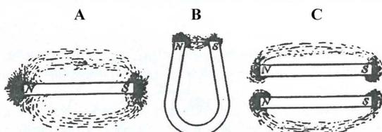
Nella Fig. 1, possiamo vedere come gli effetti magnetici di una barra e di magneti a forma di ferro di cavallo influenzano l'un l'altro: (a) è una barra magnetica che mostra il flusso magnetico dai poli (i segni neri sono limatura di ferro per tracciare le linee di campo magnetico); (b) la figura mostra un magnete a forma di ferro di cavallo e i campi magnetici attorno ai poli; (c) mostra due barre magnetiche, una accanto all'altra, notate che i poli simili allontanano la forza magnetica
